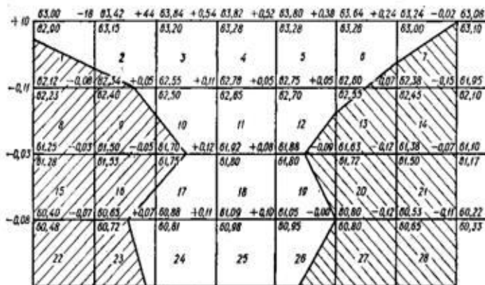
Рис. 5. Картограмма земляных работ при вертикальной планировке и подсчете земляных работ по квадратам.
